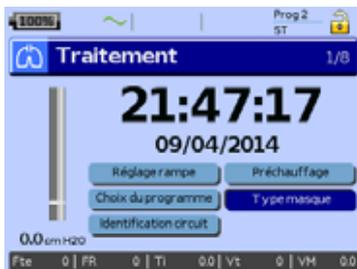
La sélection du type de masque et l'exécution de la fonction Identification circuit permettent de calculer l'impédance et la fuite pour assurer un contrôle de la pression de traitement. Voir « Menu Réglages : Options », page 50.
