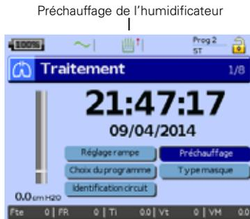
Vous pouvez utiliser la fonction de préchauffage pour préchauffer l'eau dans l'humidificateur avant de démarrer le traitement. L'humidificateur est automatiquement détecté lorsque l'appareil est mis sous tension. Une option de préchauffage de l'humidificateur est aussi fournie dans l'écran *Traitement*. Si l'humidificateur chauffe, le symbole correspondant s'affiche en haut de l'écran LCD.
