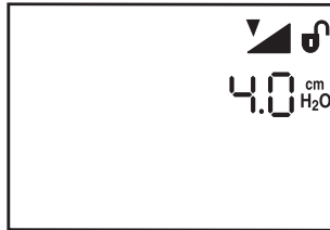
Figure 6–9 Écran de réglage de la pression de rampe de départ
