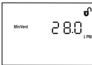
Figure 6–12 Écran de réglage de l'alarme de ventilation par minute basse
