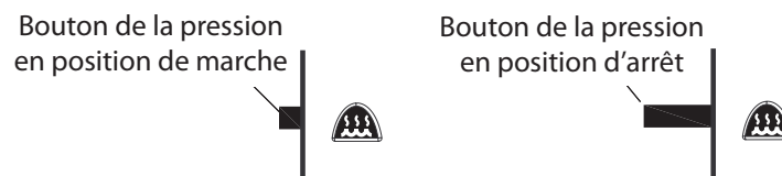
Figure 4–4 Touche de marche/arrêt de pression (sur le côté de l'appareil)
