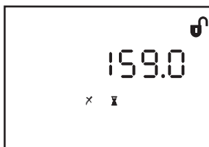
Figure 6–13 Écran de réglage de la réinitialisation du compteur de traitement
